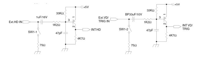
Fig. 5. HD and VD/Trigger input
